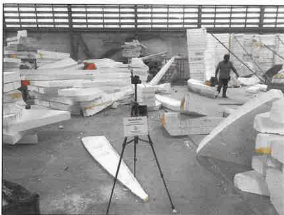
โรงงานผลิต GRC : บริเวณกลาง Line โรงผลิต ตรวจวัด Total Dust
